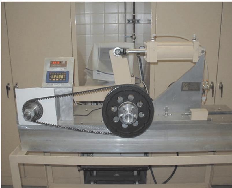
Prüfstand zur dynamischen Simulation von Motorradantrieben
